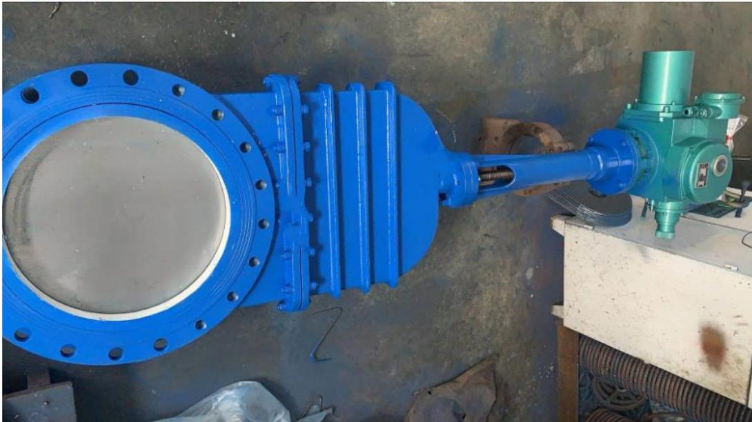
图 5.1-1 厂区雨污阀截断阀
