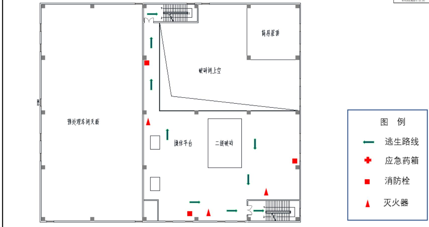
附图 8-2 公司水泥窑协同处置车间二层突发事故安全逃生路线及消防应急设施布置图
