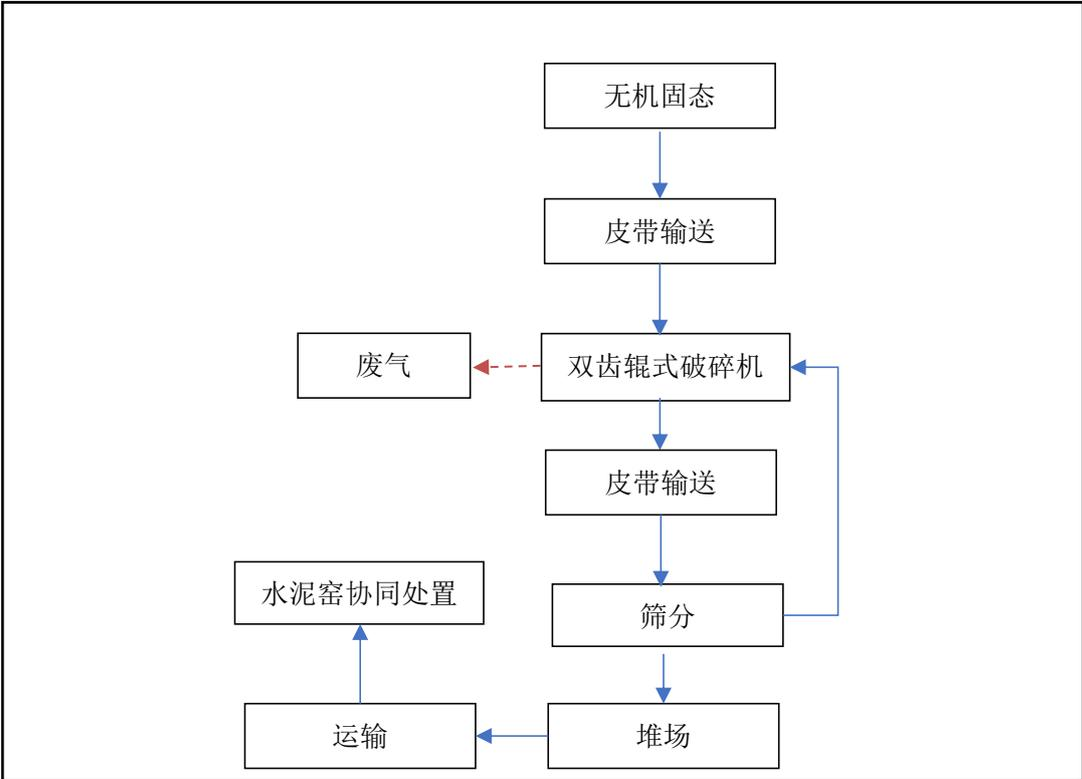
图 2.1-10 无机固态危险废物预处理工艺流程及产污环节图
