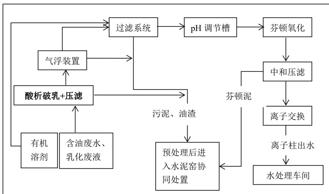
图 2.1-7 有机溶剂、含油废液、乳化废液处理工艺流程及产污环节图
