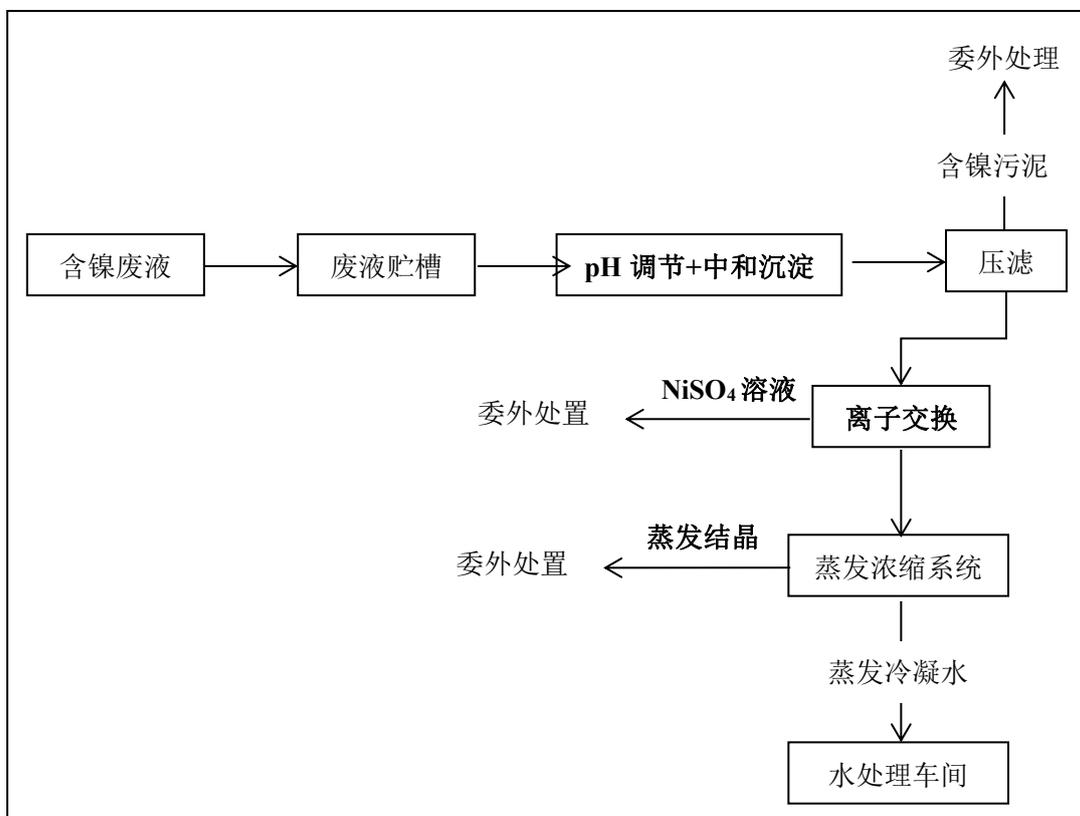
图 2.1-6 含镍废液处理工艺流程及产污环节图
