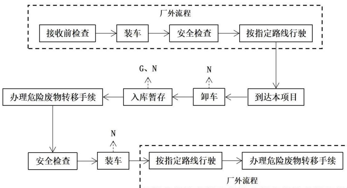
噪声：N生产噪声；废气：G有机废气、酸性废气、臭气。
