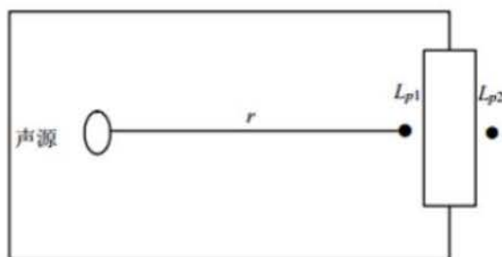
图 6.2-7 室内声源等效为室外声源图例
