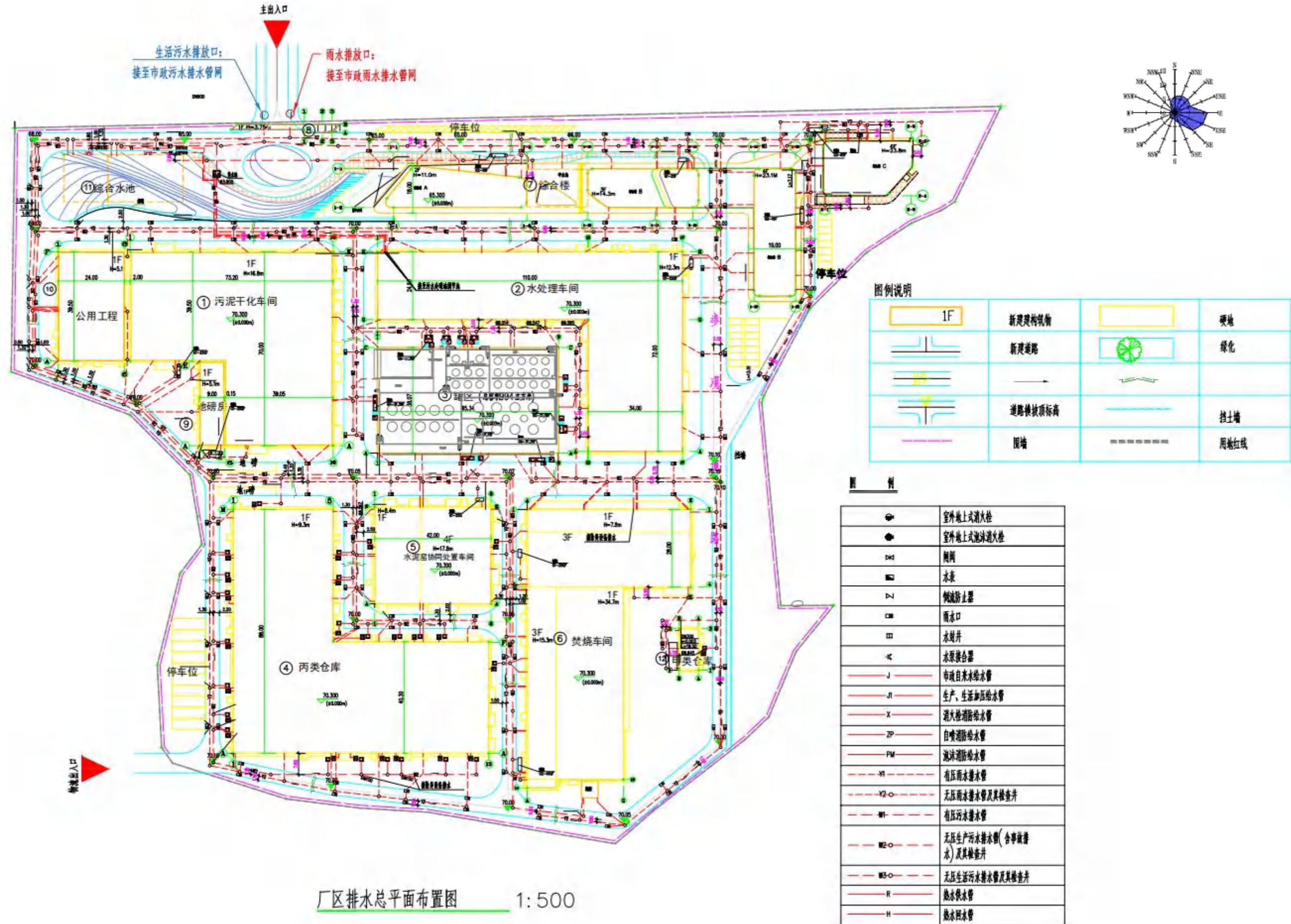
附件7-1：厂区雨污水收集管网图
