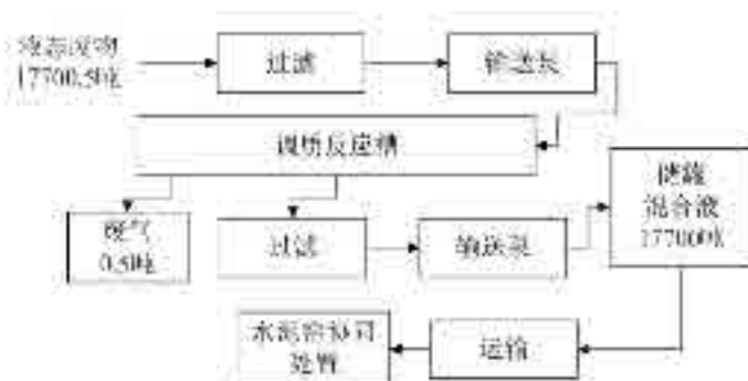
图 3.5-10 液态废物预处理工艺流程
