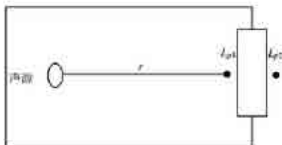
图 6.2-24 室内声源等效为室外声源图例
