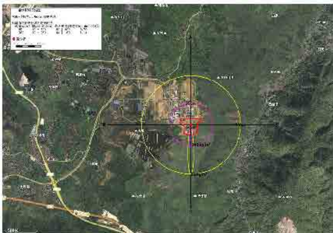
图 7.6-3 火灾伴生/次生 CO 排放最大影响区域图（最不利气象条件）
